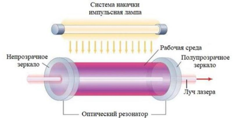
системы накачки, рабочей среды и оптического резонатора.
