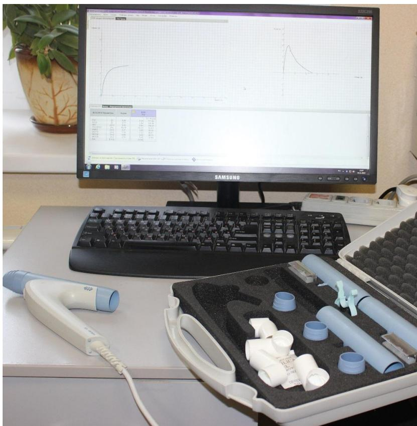
Рис. 12. Пневмотахограф BTL-08 SPIRO PC
