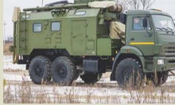
Отдельного упоминания достойна команда штабная машина Р-125Б-2М-Р. Замена трансмисии и мотора ЯАЗ на форсированный двигатель существенно улучшила трудоизносостойкость позволяя добиться уменьшения числа демонтирующих признаков. При разработке новой версии КШМ внешние вводы и вытки были установлены таким образом, чтобы автомобиль не выделялся в городском транспортном потоке.
